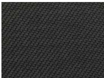
Glasfasergewebe Gewebe aus PVC-ummantelten Glasfasergarnen, Webart Sergé
